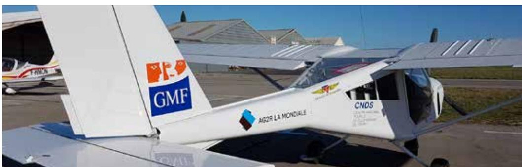
ULM innovant (type A22L2(P)-AEROPRAKT LTD) adapté aux personnes en situation de handicap (poignée triple fonction avec fonction malonnier latéral et chargement du fauteuil par la soute).
